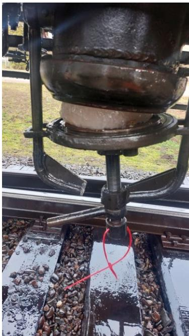
Фото 1 – Ледяная пробка в нижнем сливном приборе вагона № 73125379.
